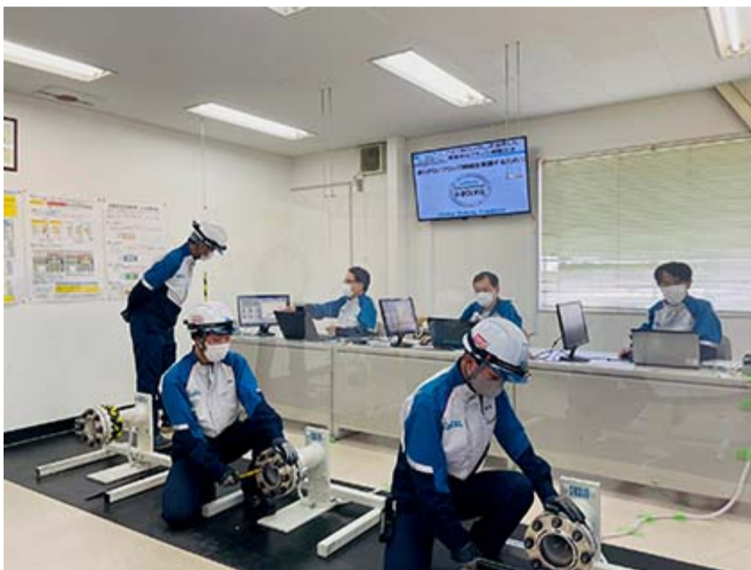
画像2 シミュレーターによる科学的なフランジ締付けトレーニング
